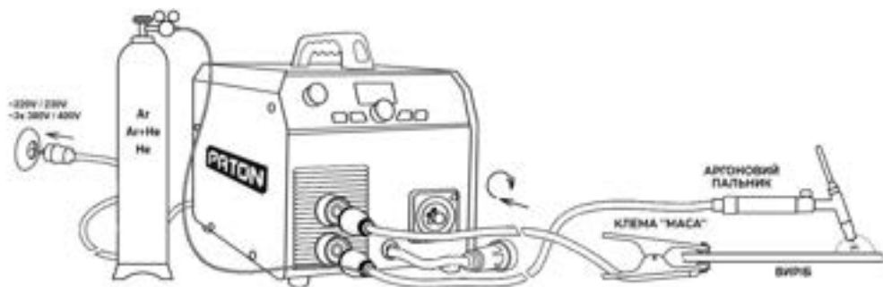
СХЕМА ПІДКЛЮЧЕННЯ АПАРАТА ДЛЯ ЗВАРЮВАННЯ В АРГОНІ (TIG) – при використанні пальника GZ-2
