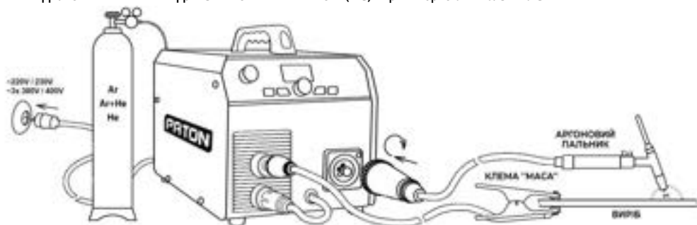
СХЕМА ПІДКЛЮЧЕННЯ АПАРАТА ДЛЯ ЗВАРЮВАННЯ В АРГОНІ (TIG) – при використанні пальника GZ-2
