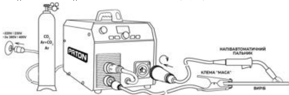
СХЕМА ПІДКЛЮЧЕННЯ АПАРАТА ДЛЯ НАПІВАВТОМАТИЧНОГО ЗВАРЮВАННЯ (MIG/MAG)
